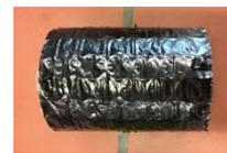
**Durchführung:** Versehe beide Modelle im Inneren mit einem Thermometer und miss die Anfangstemperatur. Schalte anschließend den Strahler ein (Abstand: 15-20 cm). **Wichtig: Der Strahler wird sehr heiß! Vorsichtig! Bringe keine schmelzbaren Sachen in unmittelbare Nähe des Strahlers.** Nimm alle 30 s den Temperaturwert auf und notiere ihn in der Tabelle.
