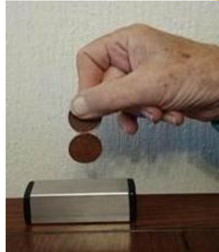
Bild 2: Das induzierte Magnetfeld hält die Münzen zusammen.
